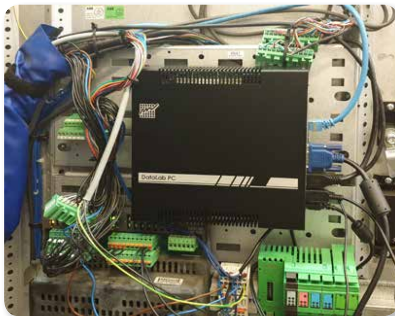
Pasivně chlazený počítač s SSD paměťovým úložištěm a operačním systémem Windows 10 IoT Enterprise LTSC
