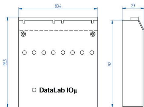
Jednotky **DataLab IO/USB** s napájením z USB sběrnice jsou tedy vhodné nejen pro pevné zabudování do rozvaděčů, ale také jako přenosné jednotky pro laboratorní měření, pro školní experimenty a laboratorní cvičení, apod. Mohou být snadno připojeny k notebookům a přenosným počítačům, v nichž není možné použít měřicí karty a které stále častěji nebývají vybaveny klasickým sériovým rozhraním.
