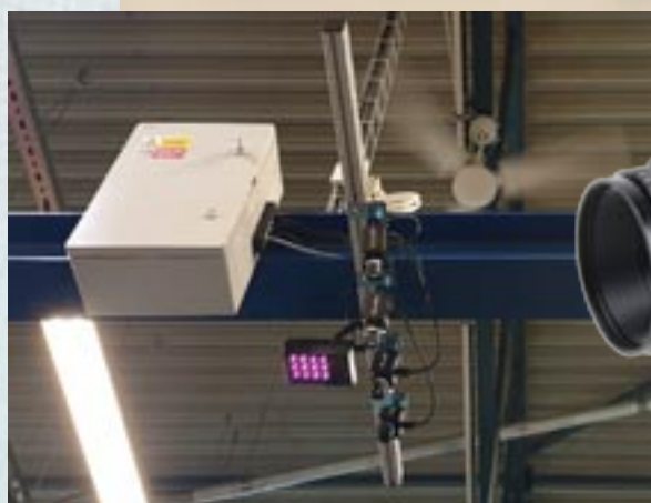
Kamery nad pracovištěm pro navigaci robota
