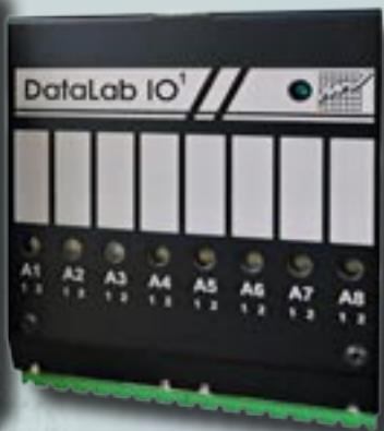
Kompaktní a standardní jednotka pro dva moduly průmyslových vstupů a výstupů
