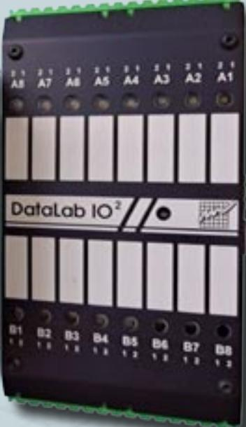
Kompaktní a standardní jednotka pro čtyři moduly průmyslových vstupů a výstupů
