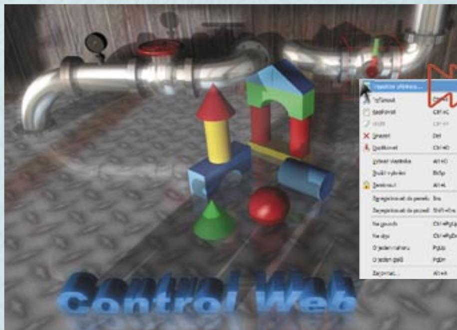
Kontextové menu nad vybraným virtuálním přístrojem umožňuje otevřít inspektor s parametry přístroje
