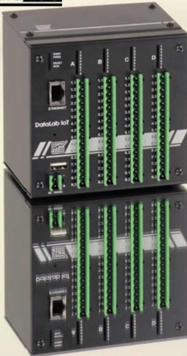
Jednotky DataLab s vestavěnými protokoly pro Internet věcí
