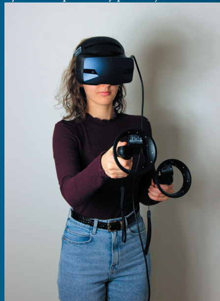
Řídicí prvky ve scéně lze ve virtuální realitě ovládat pomocí prostorových ovladačů
