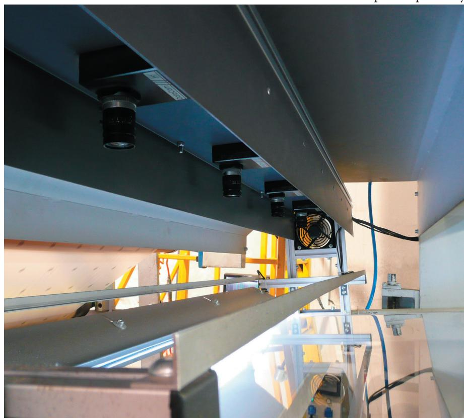
Čtevící kamery **DataCam** snímají celou šířku pásu na výstupu výrobní linky
