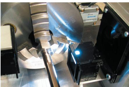
S měřením rozměrů součástek se zaoblenými a navíc lesklými povrchy bývá vždy potíž. Přesnou detekci obrysů komplikují četné odlesky v jejich blízkosti. Námi měřené tyče jsou navíc v jednom rozměru hodně dlouhé. Jsme tedy nutni kombinovat optiku s přesnou mechanikou.
