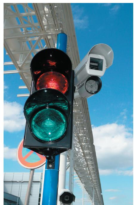
Kamera na sloupku odjezdového semaforu
