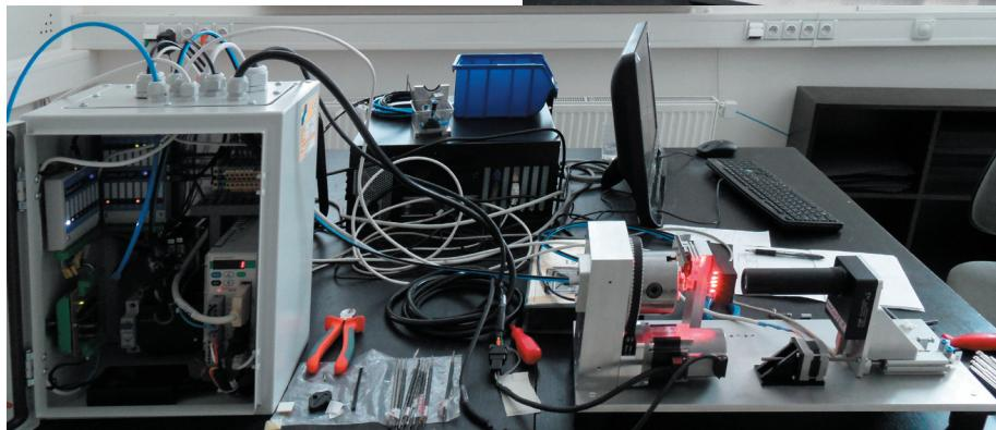
Malý rozvaděč s elektrickou instalací a jednotkami DataLab a zatím i řízení servopohonu
