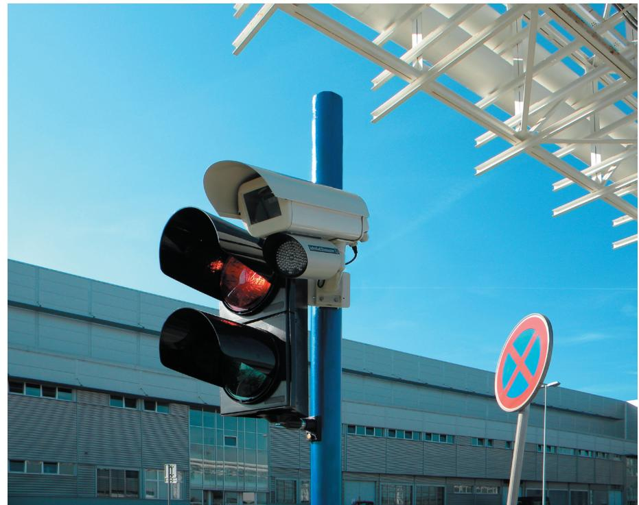
Kamera DataCam v klimaticky odolném pouzdro s vyhříváním čelního skla a napájecím zdrojem pro osvětlovač v blízkém infračerveném pásmu.
