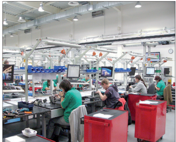
Obr. 2. Linka na výrobu komponent pro inteligentní rozváděče MNS iS ve výrobní jednotce přístrojů a rozváděčů nízkého napětí společnosti ABB v Brně
