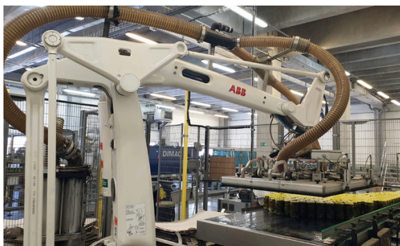
Robot ABB při rozebírání stohů palet a přenášení sklenic na pohyblivý pás.
