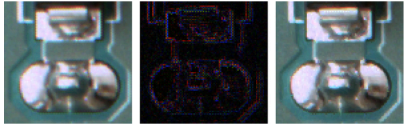
Obr. 3 Rozdílový obraz mezi bilineární a adaptivní interpolací
