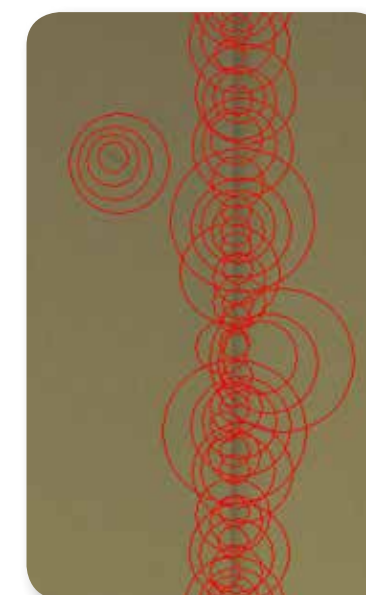
Obr. 5: Multiměřítková detekce povrchových defektů
