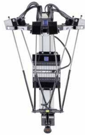
Pro ovládání manipulátoru stačí jednotka DataLab s moduly řízení krokových motorů
