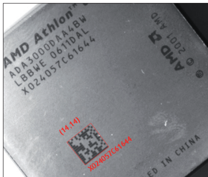
Obr. 2. Identifikace obrazce maticového kódu
