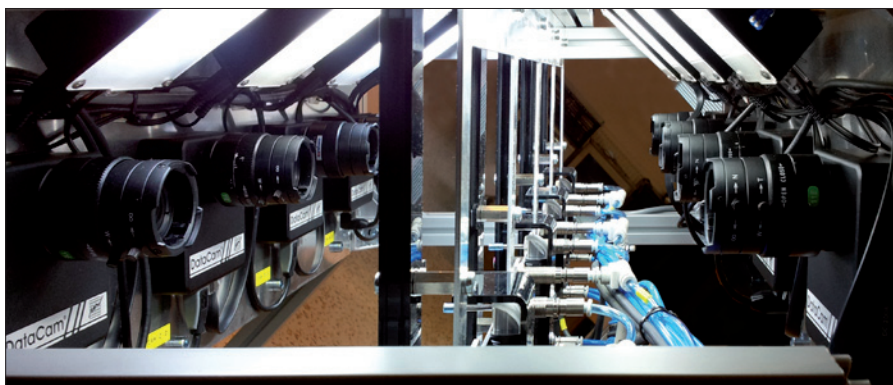
Obr. 2. Osm kamer DataCam uvnitř stroje pro kontrolu kvality výrobků
