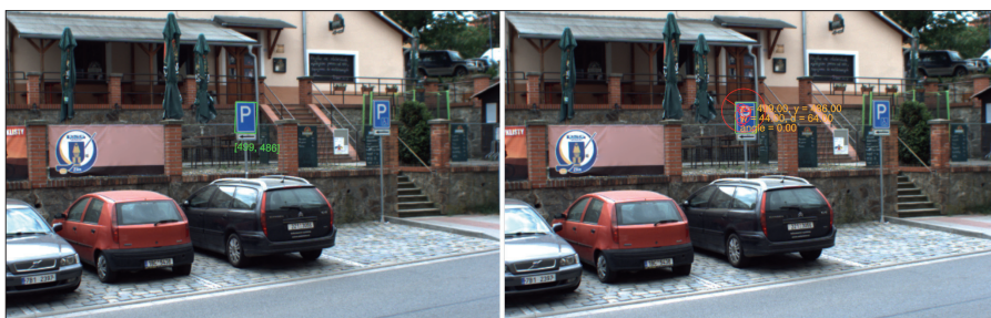
Obr. 6. Pomocí významných bodů lze v obraze z kamery identifikovat např. dopravní značky
