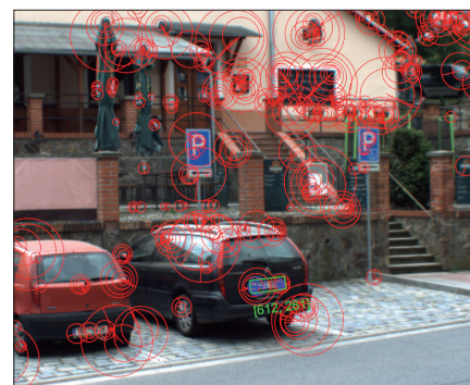
Obr. 8. ... a poté jej lze spolehlivě ve videozáznamu detekovat (červeně jsou označeny všechny nalezené významné body aktuálního obrazu)
