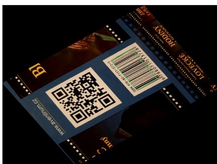
Obr. 7. Čárový kód nalezený v obraze s různými druhy periodických struktur
